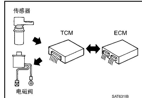
诊断间歇性错误比持续性错误难得多。大多数间歇性错误是由于电路接触不良或者线路故障造成的。在这种情况下，应仔细检查有疑问的电路，以免不必要地更换正常的零部件。
